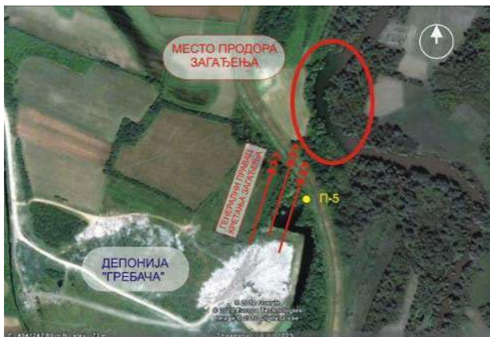
Слика 2 - Сателитски снимак загађења Колубаре проузрокованог процедним водама са градске депоније "Гребача"
