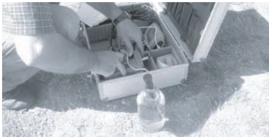
Мерење температуре воде и других физичкохемијских показатеља на лицу места
