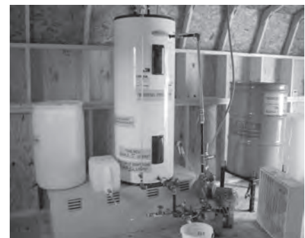
мини постројење за производњу биодизела из отпадног јестивог уља
