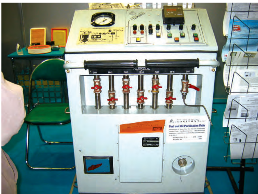
Уређај за пречишћавање моторних уља, капацитета 600 - 1500 литара на сат
