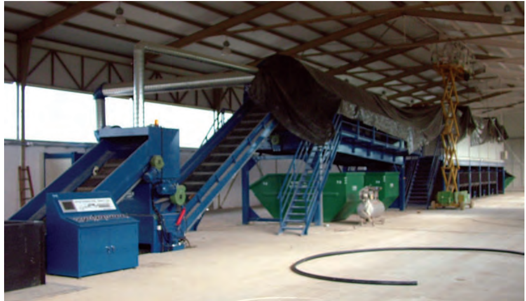
Смеће прво долази на отварач врећа, па се тракама транспортује на сепарацију
