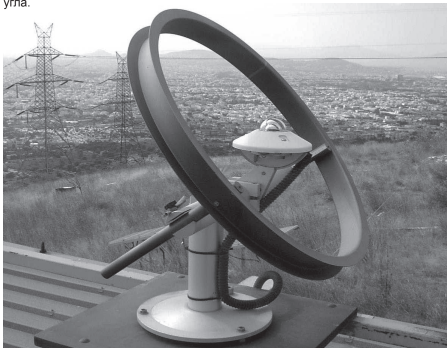
Пиранометар за мерење само дифузне компоненте зрачења
