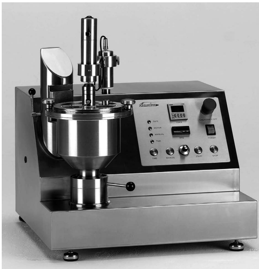
Лабораторијски миксер се користи за хомогенизацију узорка
