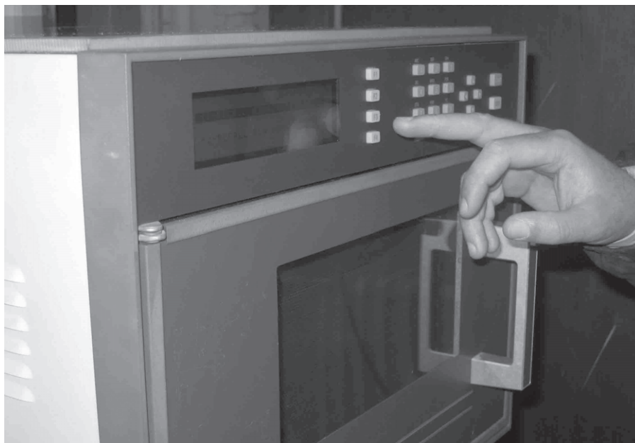
Подешавање режима у микроталасној пећници са тефлонским бомбама
