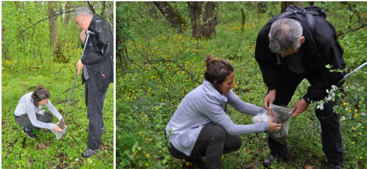
Слика 6. Узимање узорака земље за анализу са сондом
