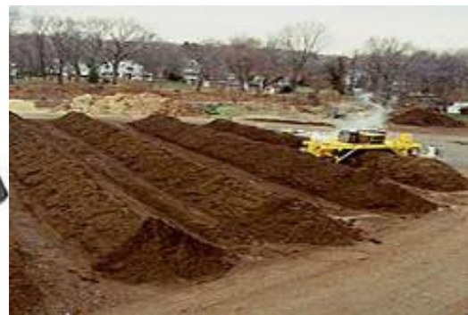
Слика 29 - Фигуре компостирања које се преврћу на отвореном простору
