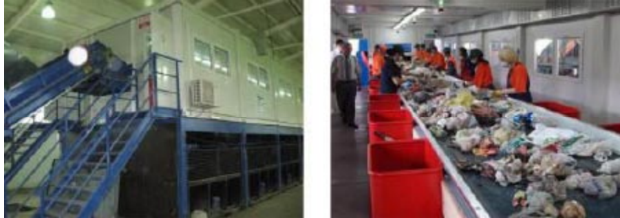
Слика 12 - Сортирна кабина и сортирна линија
